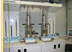
液状化試験装置
